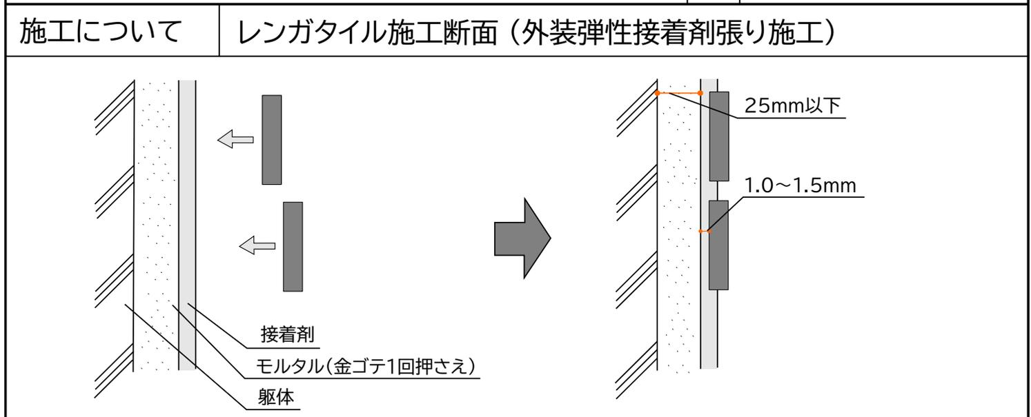
本レンガタイル施工は、外装弾性接着剤を下地に塗り、貼り付けていく工法です。接着剤は弾性があり、建物の動きを吸収できるため、剥離の危険性やひび割れが軽減できます。また、モルタル張りとは異なり、目地詰めなしでも施工でき、陰影感のある壁面に仕上がります。下地は精度よく、かつ乾燥していることが大切です。ALC・押出成形セメント板にも適用できます。
